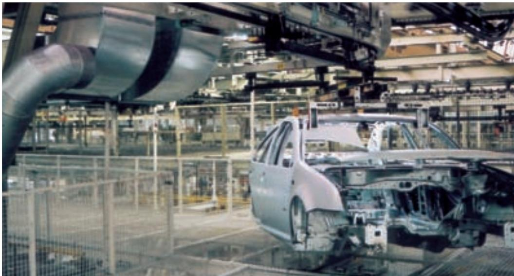
Vertikalumsetzer mit dreigeteilter Rollenbahn zur Karosserientnahme aus einem Quergurtförderer
