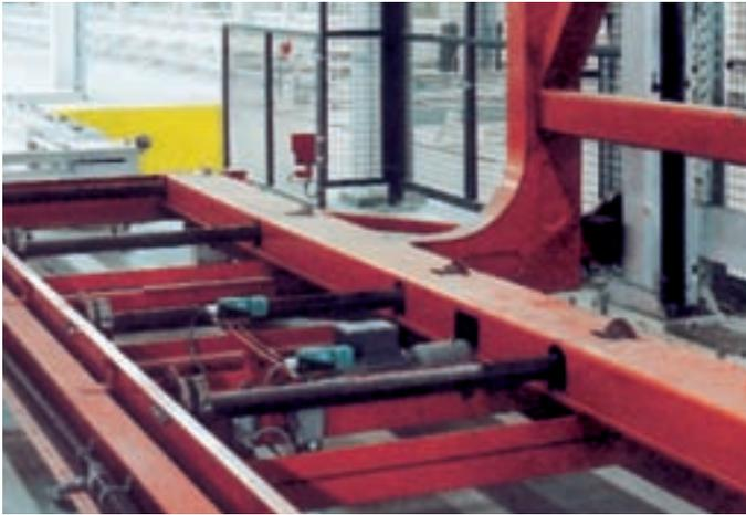
Die Skidfördertechnik bietet mit der Vielfalt einsetzbarer Einzelförderer eine hohe Anpassungsfähigkeit
