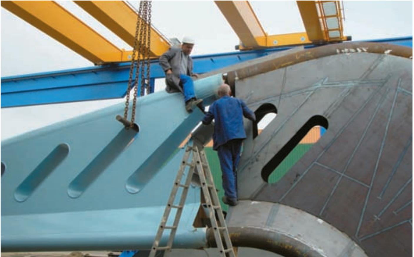
Im obigen Foto erfolgt die Kontrolle der Passfähigkeit des Baustellenstosses an einer anspruchsvollen Blech-Rohrkonstruktion.
