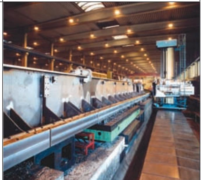
**24 Weichensegmente à 26 m Länge** mussten oben und seitlich auf Maß gefräst werden. Mit einem CNC-Bearbeitungszentrum (Foto) wurden anschließend die Nutenführungen sowie die Bohrungen zur kraftschlüssigen Befestigung der Statorpakete und für den Verbindungsstoß an den Trägern hergestellt.
