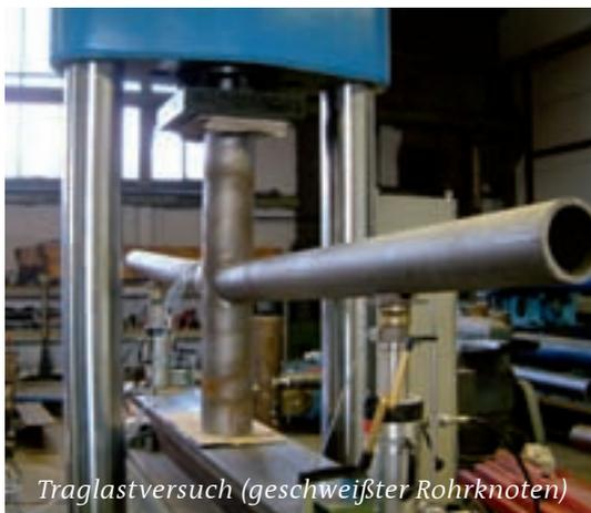
*Traglastversuch (geschweißter Rohrknoten)*
