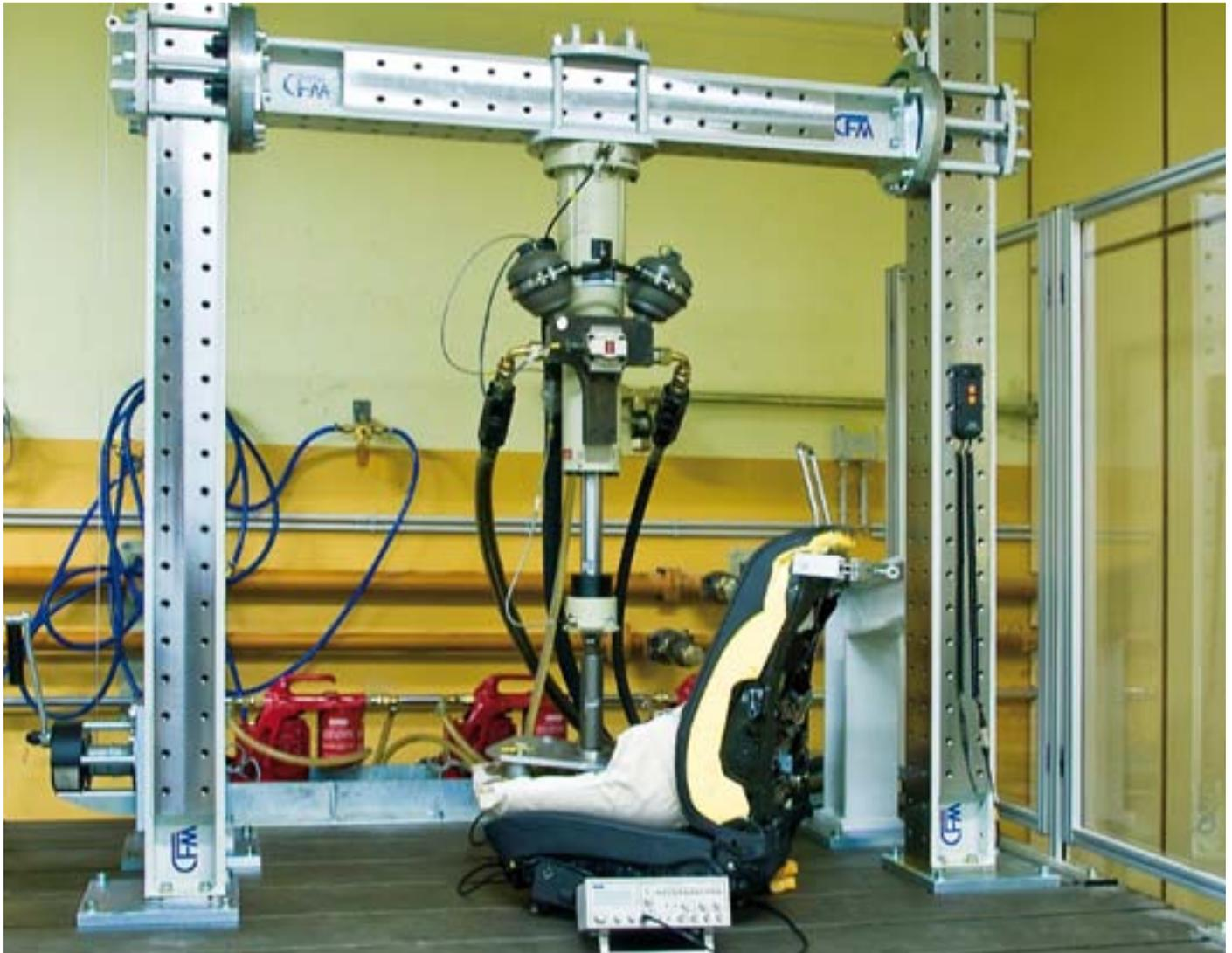
Die Prüfzylinder beinhalten ein universelles Spannbaustandsystem, das für die individuellen Kundenanforderungen modular eingesetzt werden kann.
