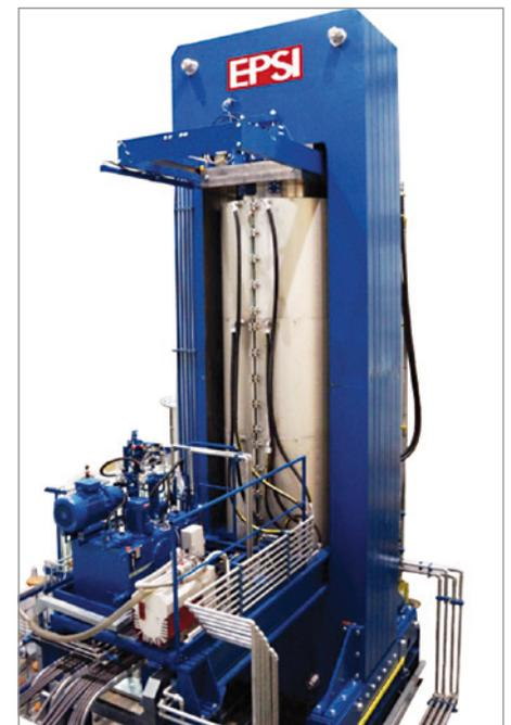
$\varnothing$  850 mm, H 2500 mm, bis 140 MPa und 1400 °C
