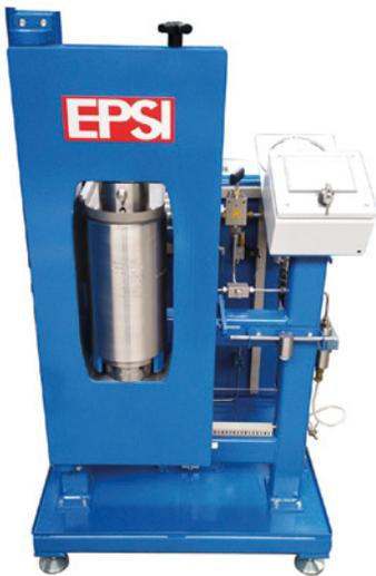
Laboranlage  $\varnothing$  78 mm, H 150 mm, bis 400 MPa
