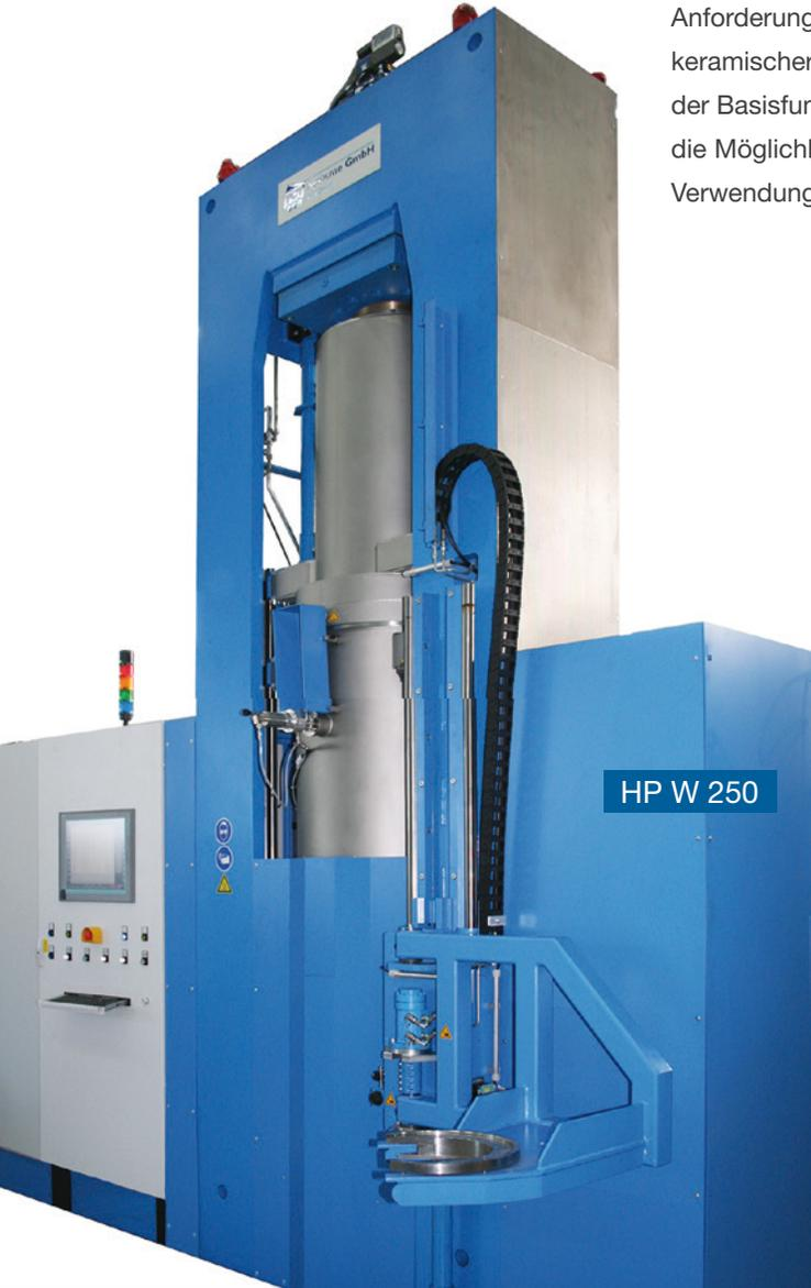
Das Konzept dieser Heißpressen für Temperaturen bis 2400 °C wurde entwickelt, um den Anforderungen bei der Entwicklung und Fertigung von Bauteilen neuer metallischer und keramischer Werkstoffe bis zu höchsten Temperaturen gerecht werden zu können. Neben der Basisfunktion dieser Anlage, dem Heißpressen mit Graphitwerkzeugen, wurde auch auf die Möglichkeit zur Durchführung von Sinterversuchen unter Vakuum und Normaldruck bei Verwendung von Ar, N<sub>2</sub> usw. Wert gelegt.
