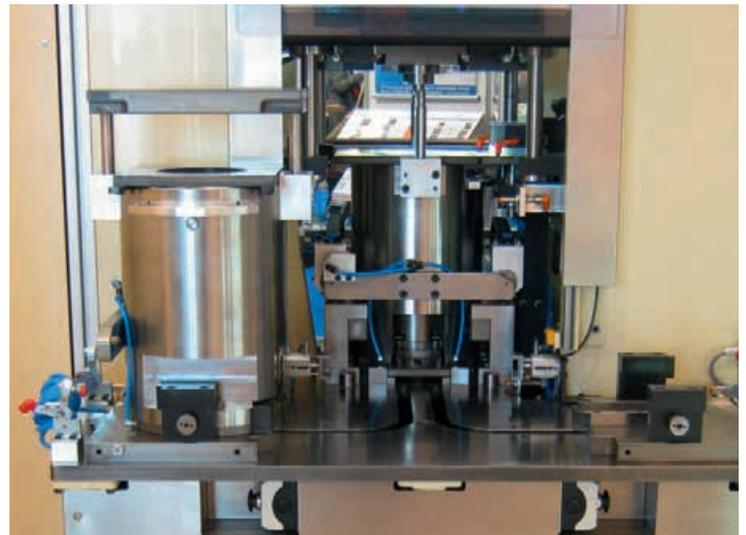
Hydraulische Axialpresse mit 500 kN Presskraft für die Herstellung von Teilen aus Keramik- und Hartmetallpulver. Vollautomatischer Werkzeugadapterwechsel. Presse und Adapter ausgelegt für sechs Regelkreise.
