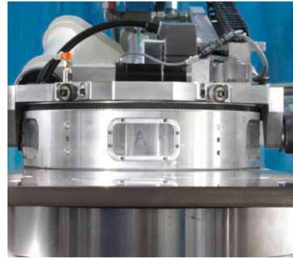
▲ **Spezielles Füllsystem mit fünf Kammern für das Füllen von unterschiedlichen Farben**
