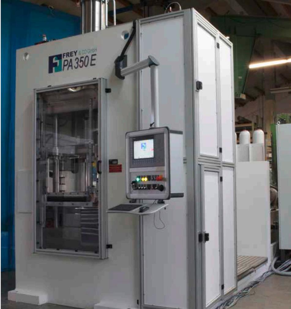
◀ **Hydraulische Axialpresse mit 3500 kN Presskraft für die Hartmetall- und Dentalindustrie.**
