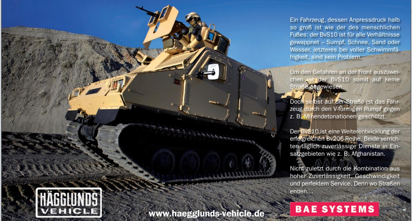
Ein Fahrzeug, dessen Anpressdruck halb so groß ist wie der des menschlichen Fußes: der BvS10 ist für alle Verhältnisse gewappnet – Sumpf, Schnee, Sand oder Wasser, letzteres bei voller Schwimmfähigkeit, sind kein Problem.
