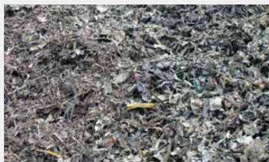
**Sorte 4** ist der sogenannte Shredderschrott aus altem Schrott, welcher zerkleinert wurde und einen Eisengehalt von mindestens 92 Prozent aufweist und auf keinen Fall größer als 200 mm sein darf.
