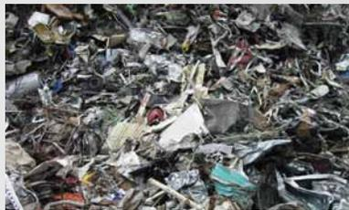
Beim Stahlschrott bezeichnet man leichten Altschrott als **Sorte 1**, die aus gebrauchten Teilen besteht, die wiederum nicht größer als 6 mm sind.
