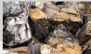
**Sorte 6** besteht aus verdichtetem Stahlneuschrott in Form von gepressten Paketen.
