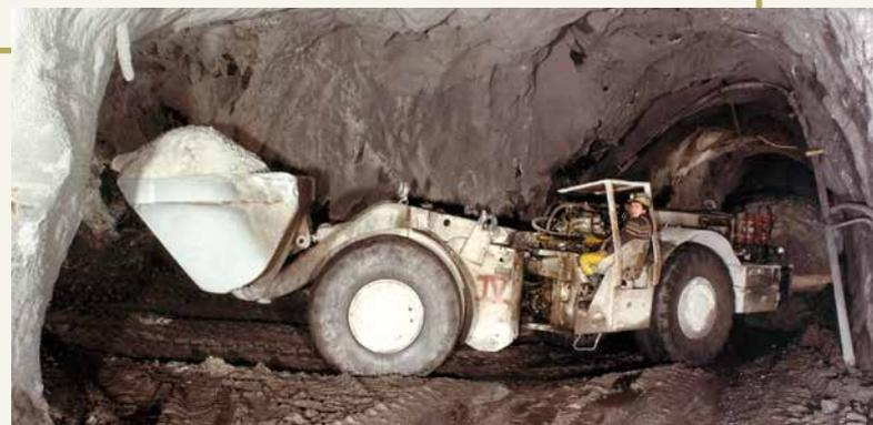
Mitte der 1970er wurde die Grube Wolkenhügel auf gleislose Technik umgestellt. Die Schachtfahrung wurde durch eine befahrbare Rampe ersetzt. So konnten LKW zur Beladung bis zur tiefsten Sohle der Grube fahren, um dort mittels Radlader beladen zu werden.
