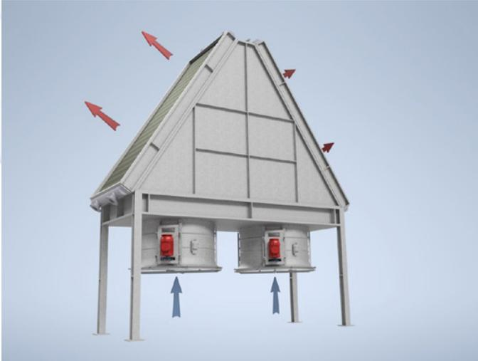
Bei eingeschränkten Platzverhältnissen werden Anlagen in Dachbauform eingesetzt. Die Ventilatoren sind drückend angeordnet.
