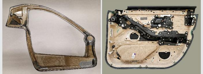
Flachs-/Kenaffaser-Polypropylen – repräsentiert die Anwendung von naturbasierten Werkstoffen in Großserie, wobei die Funktionsfähigkeit des Materials über die gesamte Bauteillebensdauer zu gewährleisten ist. Naturbasierte Werkstoffe sind ein essenzieller Forschungsschwerpunkt an der Professur Strukturleichtbau und Kunststoffverarbeitung der TU Chemnitz.
