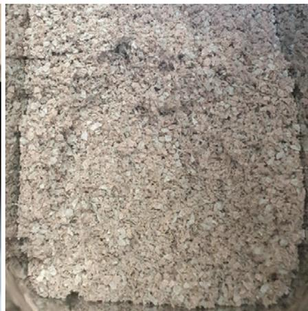
Abb. 2: Compoundiersuche links: NF/PP-PET-Schnitzel mit geringer Schüttdichte; rechts: Compounder mit Stopfwerk (rot) für die Materialdosierung
