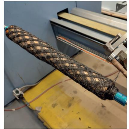
Abb. 3: Herstellung der Rohrsegmente mittels Trockenwickelverfahren
