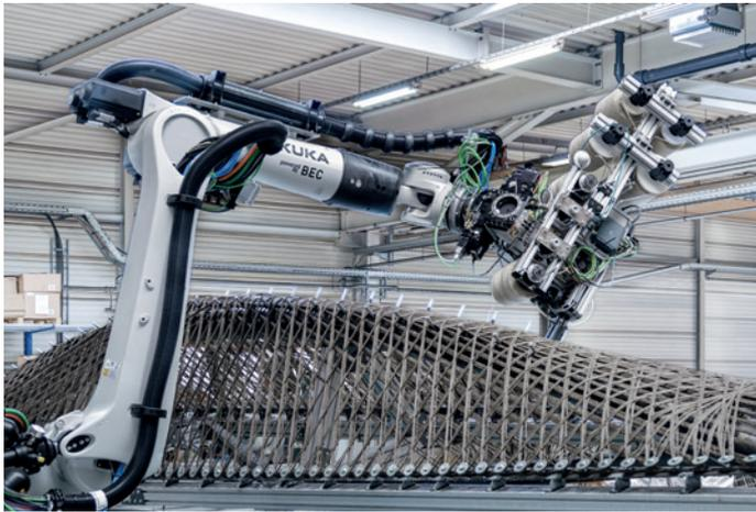
Abb. 2: Robotische Prototypenfertigung im kernlosen Faserwickelprozess © ICD/ITKE/IntCDC Universität Stuttgart
