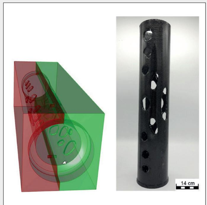
Abb. 2: links: Konzept der Werkzeugform, rechts: fertiger Demonstrator
