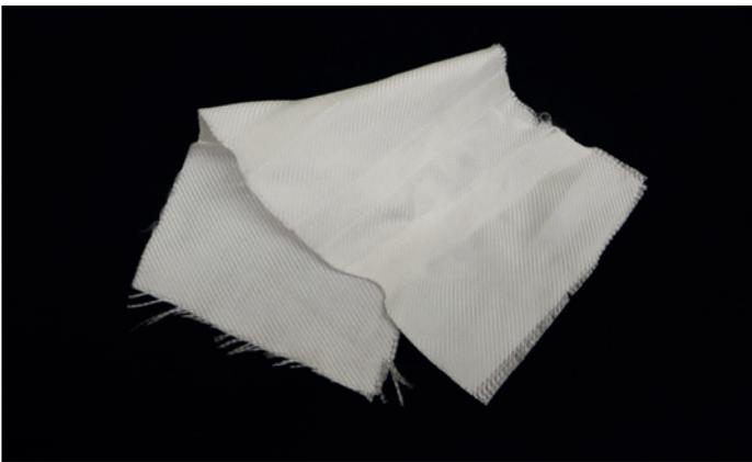
Abb. 2: srPLA-Gewebe mit direkt integrierten Versteifungsrippen durch eine teilweise Konsolidierung
