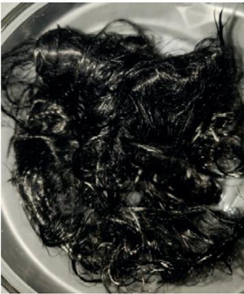
Abb. 1: Rückgewonnene Carbonfasern nach der Solvolyse
