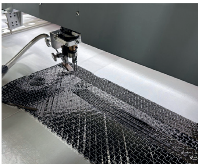
Fertigung des TFP-Preforms mit lokalen Verstärkungselementen. Production of the TFP preform with local reinforcement elements.
