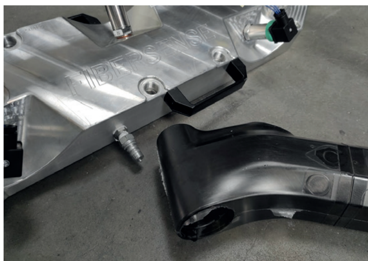
Werkzeug zur Fertigung des Fahrradrahmens und Referenzrahmen aus Prepreg. Tool for producing the bicycle frame and reference frame made of prepreg.
