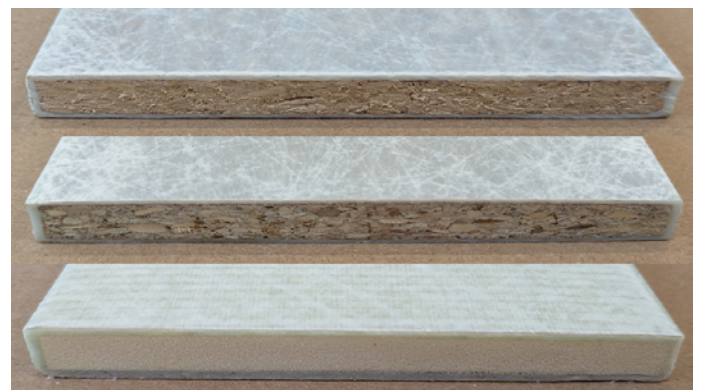
Abb. 1: Hergestellte Sandwich-Flachprofile mit Kernen aus Myzel (Oben), Spanplatte (Mitte) und PU-Schaum (Unten)
