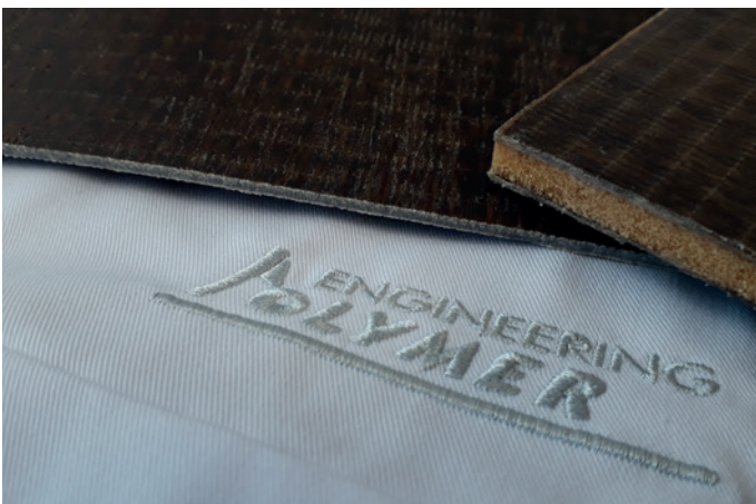
Abb. 2: Vollständig biobasiertes Sandwich als Demonstratorbauteil
