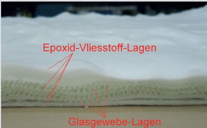
Abb. 3: Lagenaufbau vor dem Pressvorgang
