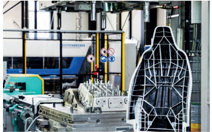
Abb. 2: Hybride Sitzlehne aus PLA und Basaltfaser (Fraunhofer ICT)
