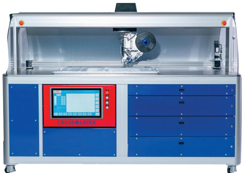
2019 erhielt die Leibniz-Institut für Verbundwerkstoffe GmbH (IVW), zusammen mit der Firma M&A Dieterle GmbH, den renommierten AVK-Preis für die Entwicklung eines Handlaminiergerätes (HLG), das die händische Ablage thermoplastischer Fasertapes auf einfach gekrümmten Oberflächen möglich macht.
