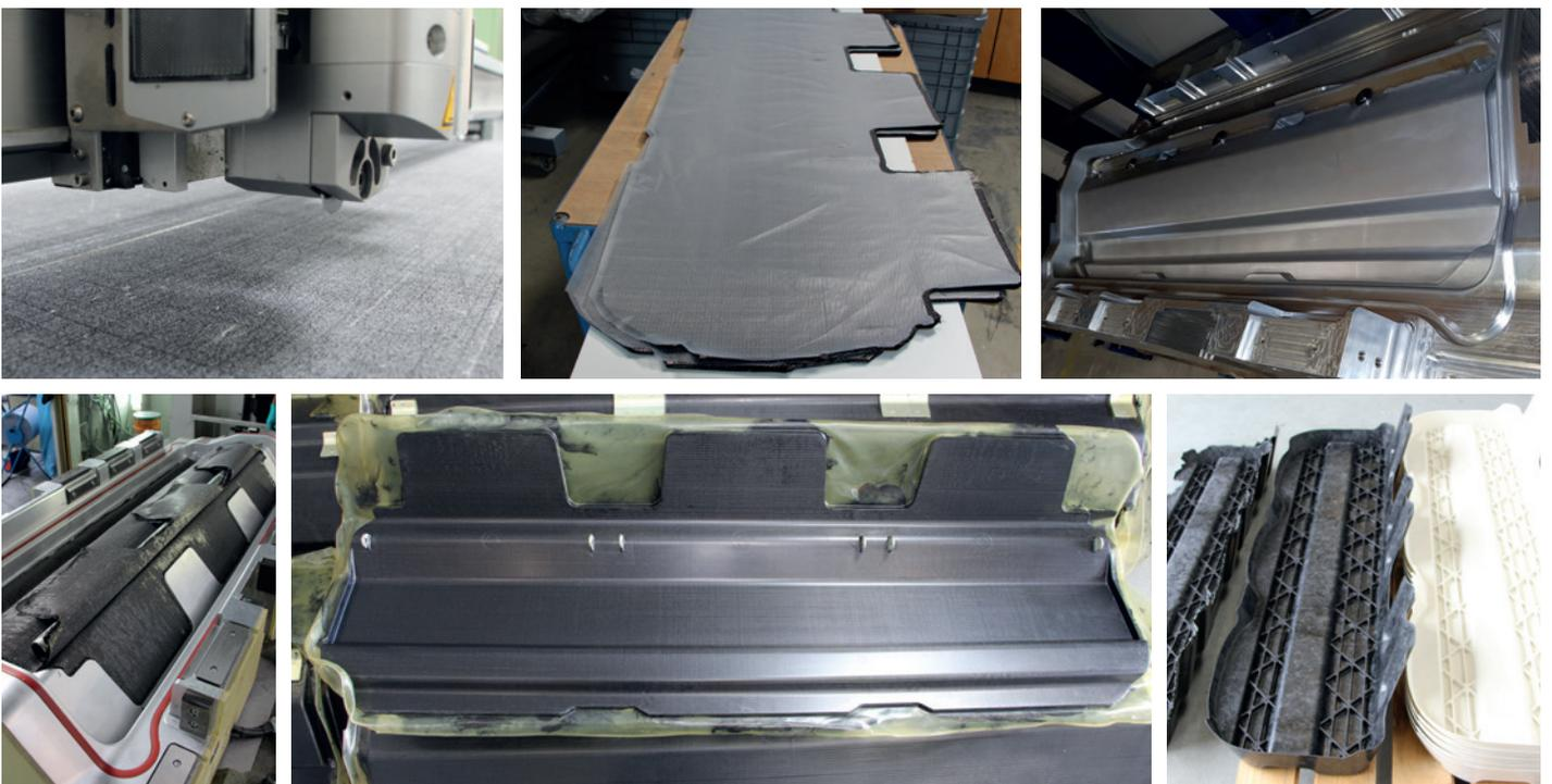
Abb. 3: Herstellung von CF-PU-Sitzoberschalen mit Metall-Inserts im „Wet Compression Moulding“-Prozess (WCM). Prozess: Die CF-PU-Sitzunter-schale (blaue Umrahmung) wird per „Sheet Moulding Compound“-Prozess (SMC) mit eingelegter CF-PU-Prepreg-Verstärkung gefertigt
