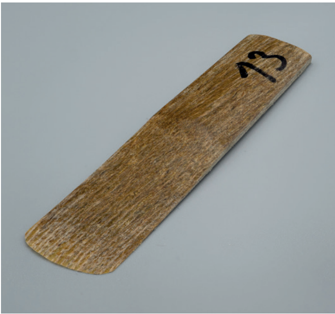
Alt-Saxophonblatt aus flachfaserverstärktem Thermoplast, entwickelt zusammen mit Harry Hartmann's Fiberreed, Oberaichen. Alto saxophone reed made of flax fibre-reinforced thermoplastic, developed together with Harry Hartmann's Fiberreed, Oberaichen.
