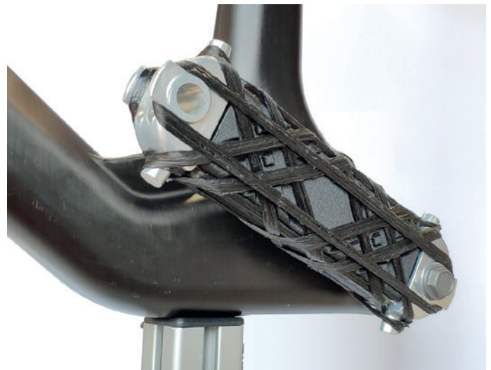
Abb. 1: 3DSW-Fahrradtretkurbel (Kern und Verstärkungsskelett aus kohlenstofffaserverstärktem Polyamid)
