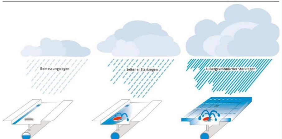
Ein Kanalnetz ist aufgrund statistisch berechneter Regenmengen so dimensioniert, dass es bestimmte Starkregenmengen (Bemessungsregen) aufnehmen kann. Erst wenn die Kapazitäten der Kanäle bei einem seltenen oder außergewöhnlichen Starkregen überschritten werden, kommt es zu einem Überstau und zum Austritt von Kanalwasser an der Oberfläche.
