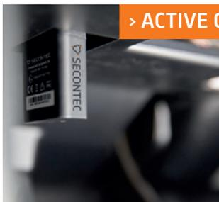
Wir haben ein aktives Car-Tracking für Mietwagen- und Vorführwagen entwickelt. Verlässt eines der Fahrzeuge einen zuvor definierten Radius erfolgt eine automatische Alarm-Meldung im rund um die Uhr besetzten VOC Video Operation Center. Unser „Geofencing“ kontrolliert und schützt Ihren Fahrzeug-Pool.
