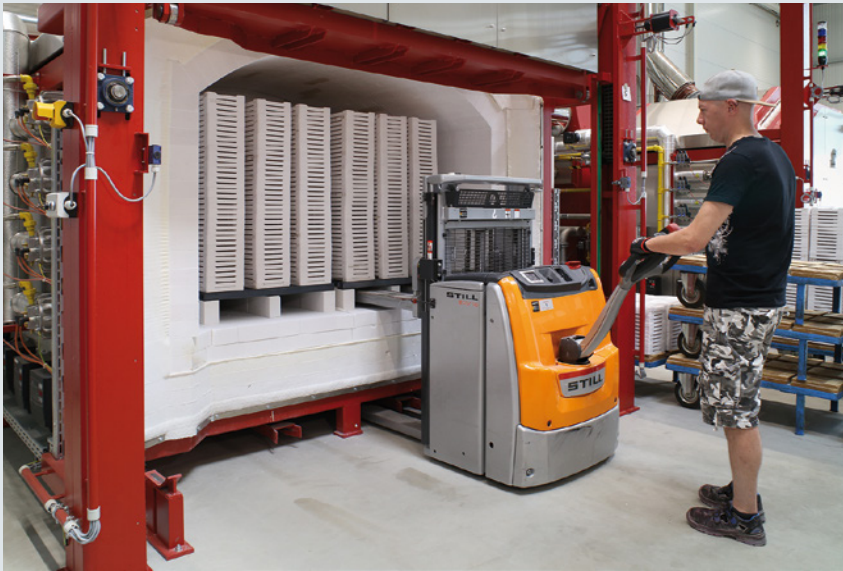
Die gepressten Teile werden im Ofen gebrannt.
