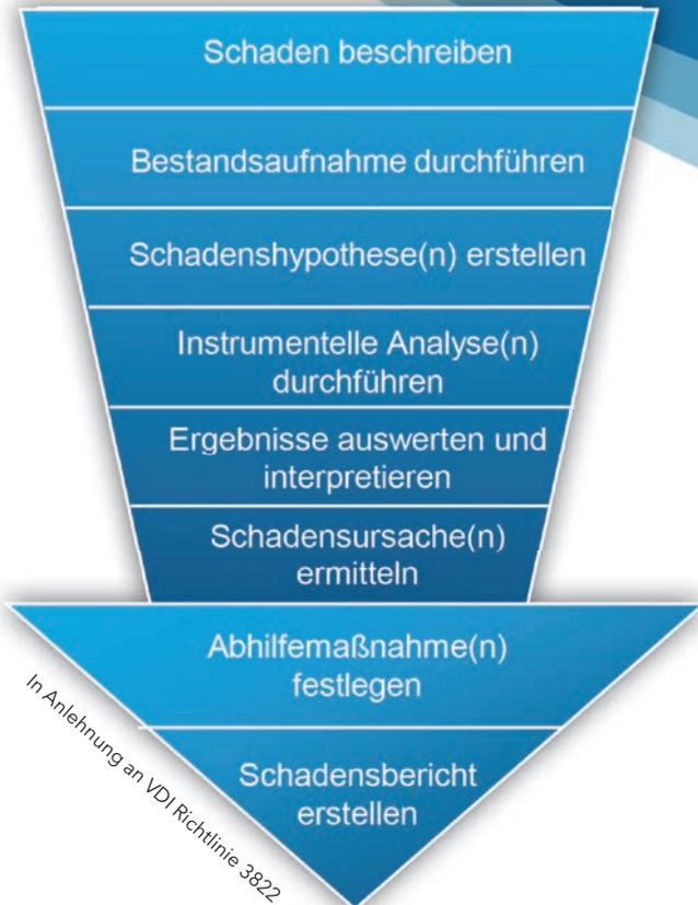
Eine systematische Schadensanalyse ist die Grundvoraussetzung, um Schadensursachen schnell und erfolgreich zu ermitteln. Das dabei gewonnene Verständnis über Schadensmechanismen, Schadensursachen und Abhilfemaßnahmen sollte dafür verwendet werden, eine erfolgreiche Werkstoffentwicklung durchzuführen und Schäden an Bauteilen präventiv zu vermeiden.
