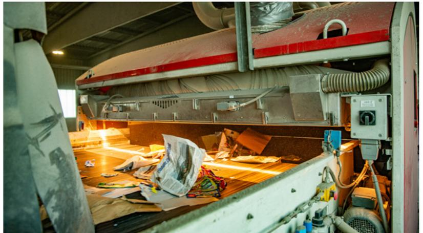
Die Wertstoffsortieranlage in Markt Berolzheim ist ein weiteres zentrales Element der Infrastruktur. Hier werden jährlich rund 50.000 Tonnen Wertstoffe sortiert, um sie dem Recyclingkreislauf wieder zuzuführen. Die Anlage verfügt über moderne Ballenpressen und Sortiertechnik, die es ermöglicht, unterschiedliche Abfälle effizient zu trennen.
