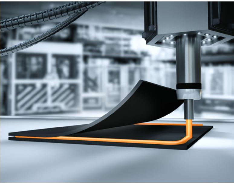
**FrechBond®** unser ein- und zweikomponentiger Polyurethan-Klebstoff: Zur Reparatur von Kunststoffteilen, zum Verfüllen von Löchern, Rissen und Fugen in Metall, Holz, Stein und Glas.
