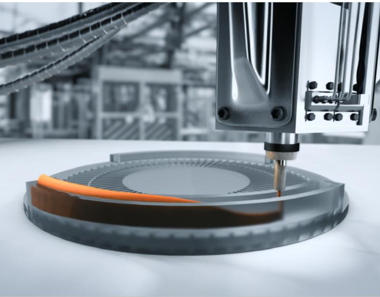
**FrechFoam®**, unser zweikomponentiger Polyurethan-Weichschaum, eignet sich hervorragend als Dichtungsschaum im FIPFG-Verfahren – für die Abdichtung Ihrer Bauteile.
