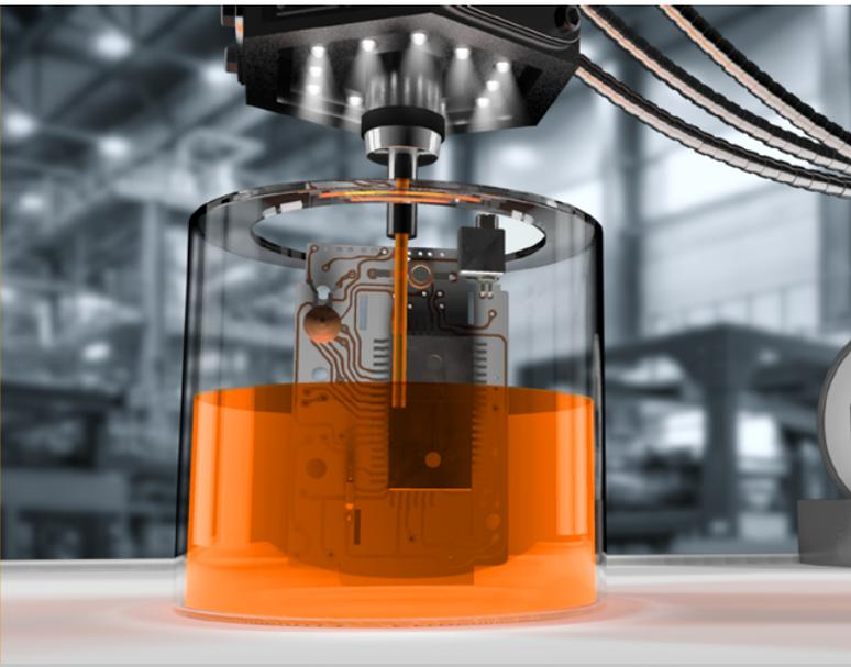
**FrechFill®**, unser Zweikomponenten-Polyurethan-Vergussmaterial. Er eignet sich hervorragend zum Vergießen von Elektro- und Filterelementen, als Rotations- oder Klarverguss.
