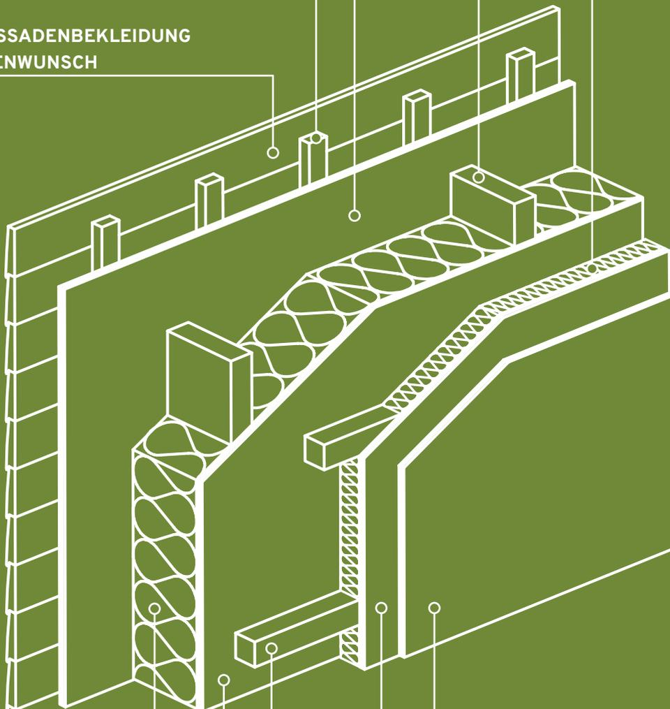
GIPSKARTONPLATTEN 2x12,5 MM
