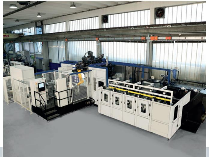
Die Buffoli-Transfer- und -Rundtaktmaschinen zeichnen sich durch ihre Flexibilität, eine durchdachte Technologie und extreme Leistungsfähigkeit aus. Die Bearbeitung der Stangenabschnitte oder Einlegeteile kann in einer Station simultan aus mehreren Richtungen erfolgen. Die Projekte werden meist Turnkey, immer häufiger auch mit integriertem Messsystem geliefert.
