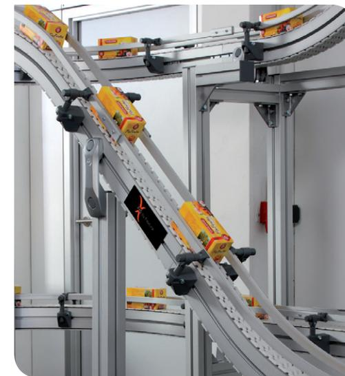
FlexLink Fördersysteme aus Aluminium oder Edelstahl transportieren Ihre Produkte in drei Dimensionen sicher, schnell und zuverlässig. Ganz gleich, ob Komponenten zur Selbstmontage, vormontierte Module oder komplette Fördersysteme: FlexLink ist mit über 40 Jahren Erfahrung Ihr verlässlicher Partner.
