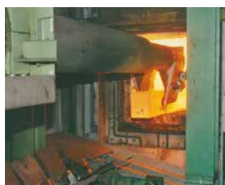
Drehherdofen-Beschickungsanlage Tragkraft: 3t
