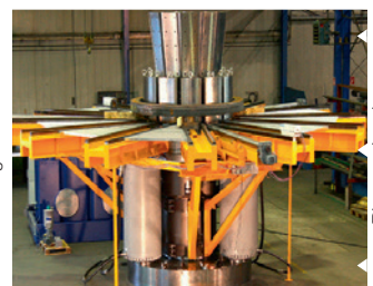
Ringspreizanlage Spreizkraft: 800t
