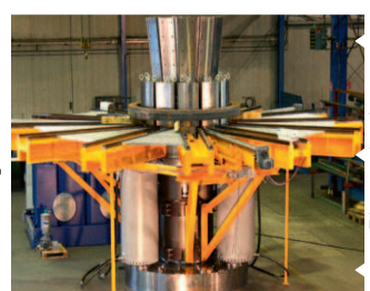
Ringspreizanlage Spreizkraft: 8000t
