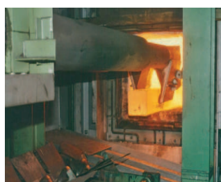
Drehherdofen-Beschickungsanlage Tragkraft: 3t
