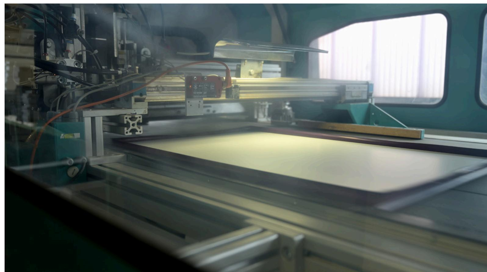
Da sich die Platte aus feinsten Holzfasern auszeichnet für die Fräs- und Bohrbearbeitung eignet, können Landhausprofile, Kofferprofile, Rahmenprofile usw. qualitativ hochwertig gefräst und modelliert werden. Später erhalten die MDF-Teile zunächst einen Leimauftrag und werden dann unter hohem Druck mit der Folie verpresst, so dass diese extrem dicht an der Oberfläche verklebt wird. Anschließend werden die Fronten mit den nötigen Bohrungen versehen.
