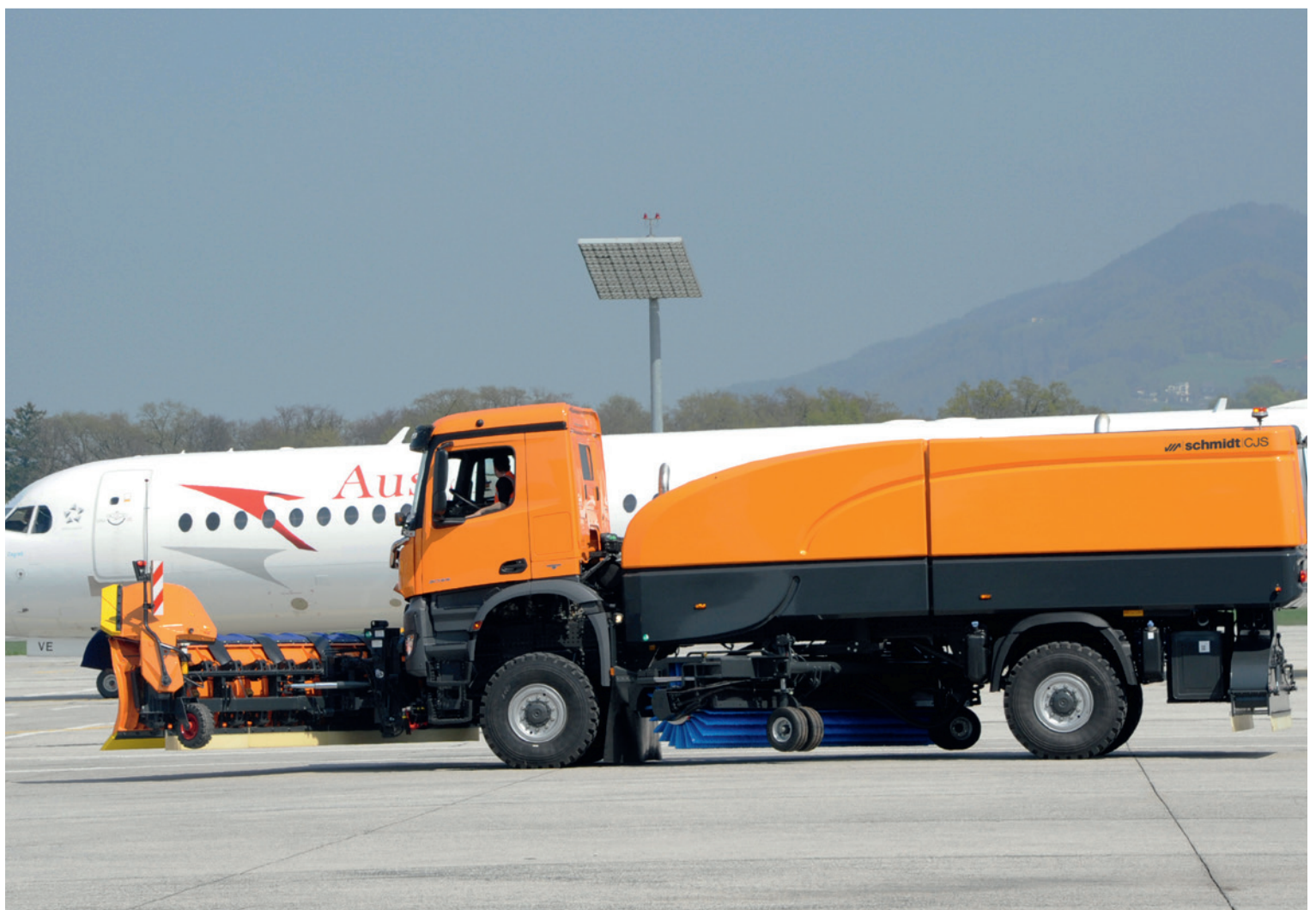
GFK-Anwendungen an Kommunalfahrzeugen: großflächige Verkleidungsteile / GRP applications on municipal vehicles: large-area cladding parts
