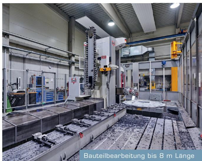
Bauteilbearbeitung bis 8 m Länge
