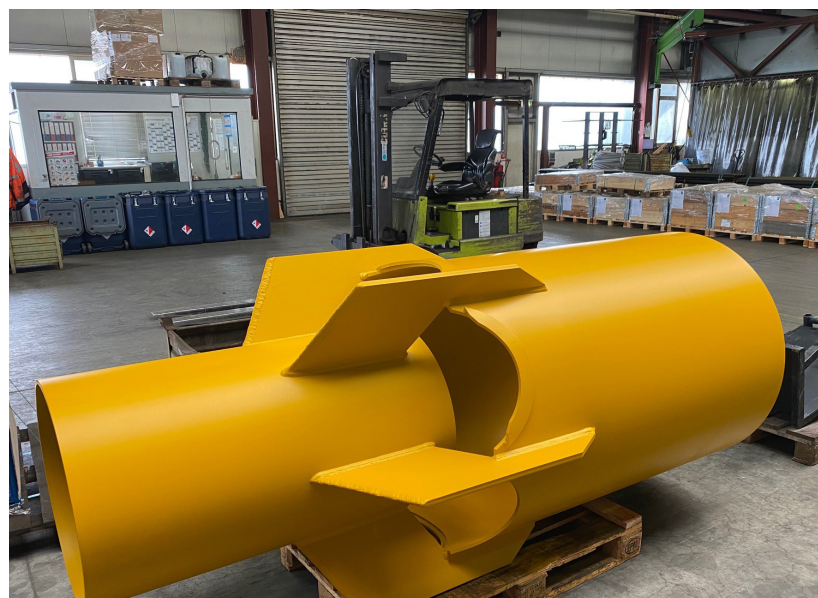
Zwischenaufweitung / Intermediate reaming head 630-1.020mm
