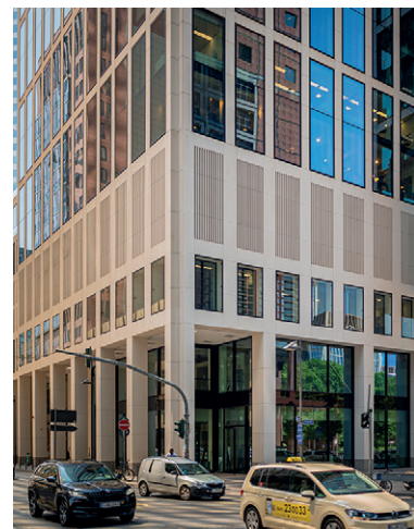
▲ raumhohe, festverglaste Fenster über zwei Geschosse mit umlaufendem Rahmen + Aluminium-Elementfassade Taunusturm, Frankfurt
