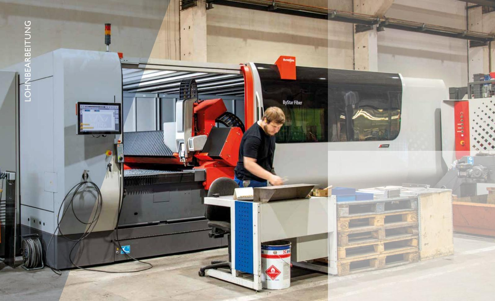
Seit 2020 steht eine neue Laserschneidanlage mit einer Laserleistung von 12 kW für Blechzuschnitte mit einer Blechstärke bis 30 mm zur Verfügung.
