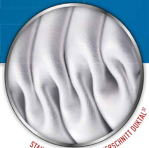
STAUCHPROBE REFERENZQUERSCHNITT DUKTAL<sup>32</sup>
