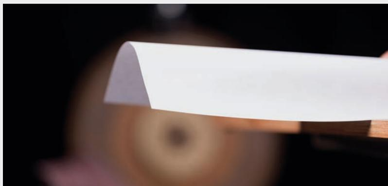
Unter Conblade verstehen wir die extrem convex und concav geformte Schneiden. Besonders anschaulich zeigt ein Blatt Papier das eine spezielle Form für enorme Stabilität sorgt. Während es im flachen Zustand abknickt erhält es durch die konvexe Form eine höhere Stabilität und behält seine Form.
