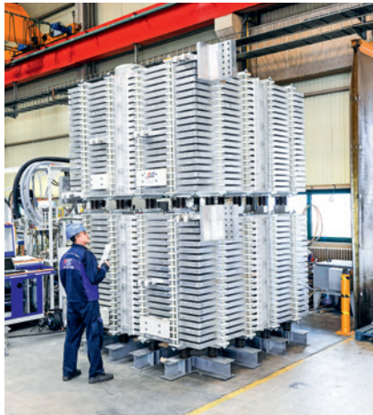
Begehbare Aluminium-Umhausungen für eine Funkenstrecke – zur kontrollierten Entladung von Serienkondensatoren auf Stromverteilungsfeldern
