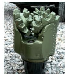
Bohrmeißel eingesetzt in der untersten Gesteinsschicht 3174 m – 3864 m (Länge der Reinjektionsbohrung).
