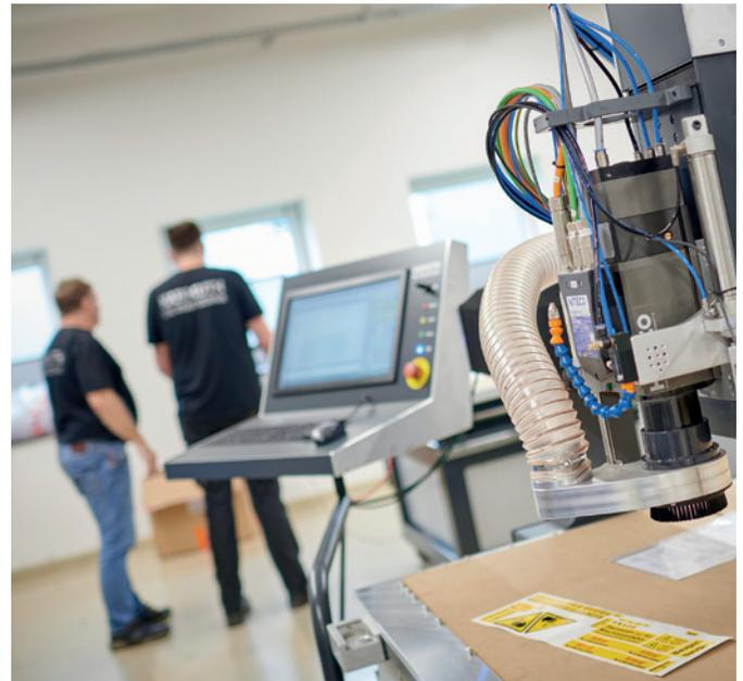
Geliefert wird die bewährte Profi-Serie 1 mit der „Penta-Tec“ V3 Software, in der energieeffizient die Vakuumleistung der Anlage entsprechend der einzelnen Fräsebenen angepasst werden kann. Zudem ermöglicht die moderne Software, dass neue Projekte programmiert werden können, während die Anlage in Betrieb ist. Der Workflow wird dadurch deutlich optimiert. Auch die integrierte Werkzeugverschleißüberwachung unterstützt einen reibungslosen Produktionsablauf.
