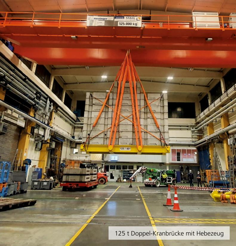
125 t Doppel-Kranbrücke mit Hebezeug
