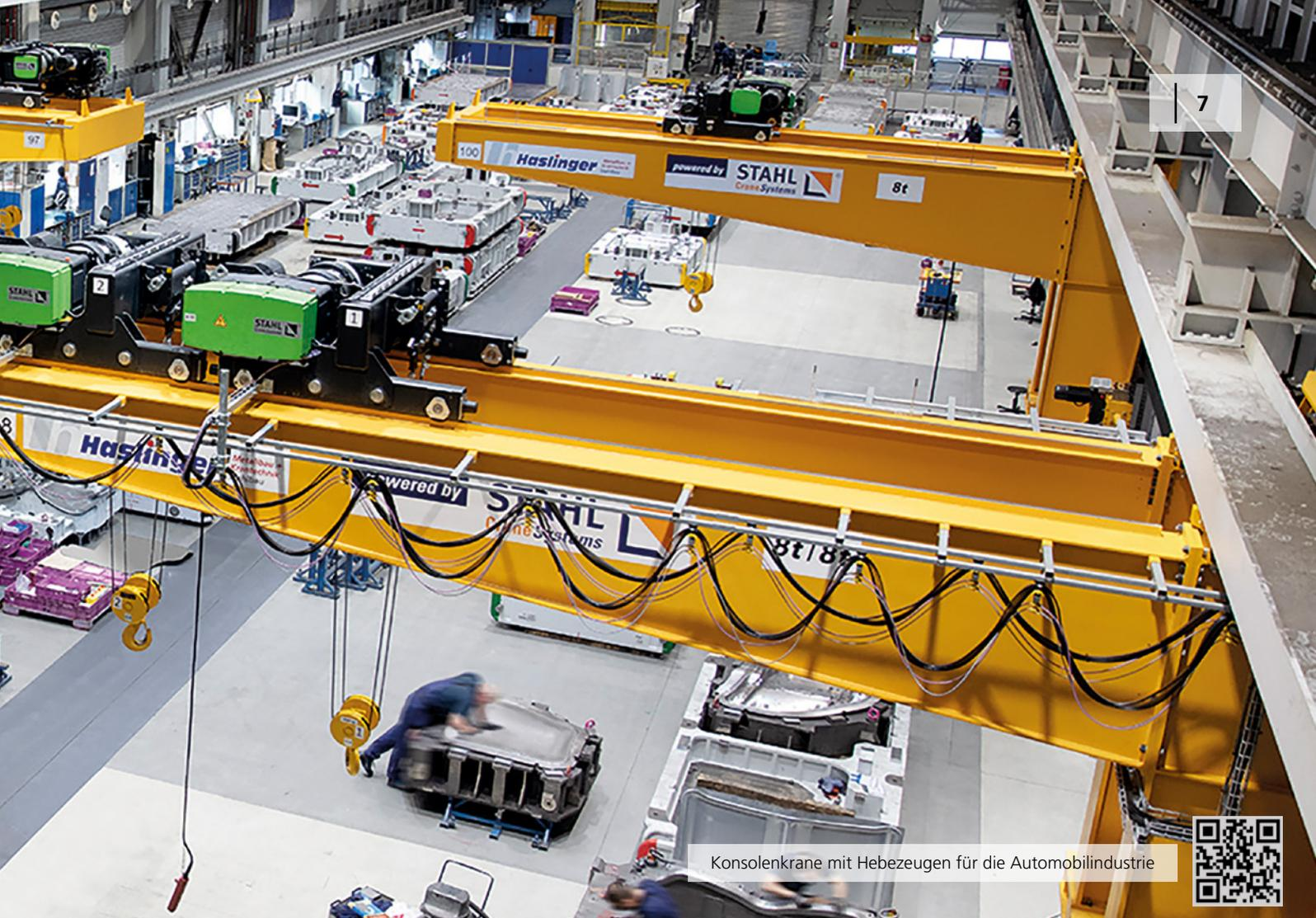
Konsolenkrane mit Hebezeugen für die Automobilindustrie
