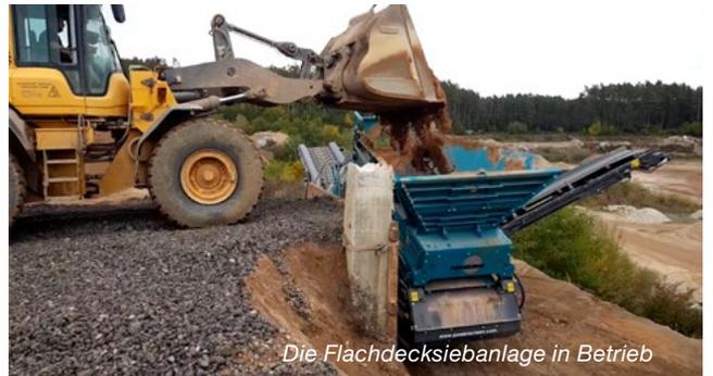
*Die Flachdecksiebanlage in Betrieb*
