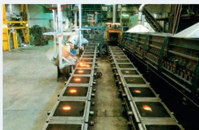
Drastische Erhöhung des Outputs durch die Investition in eine vollautomatische Formanlage.
