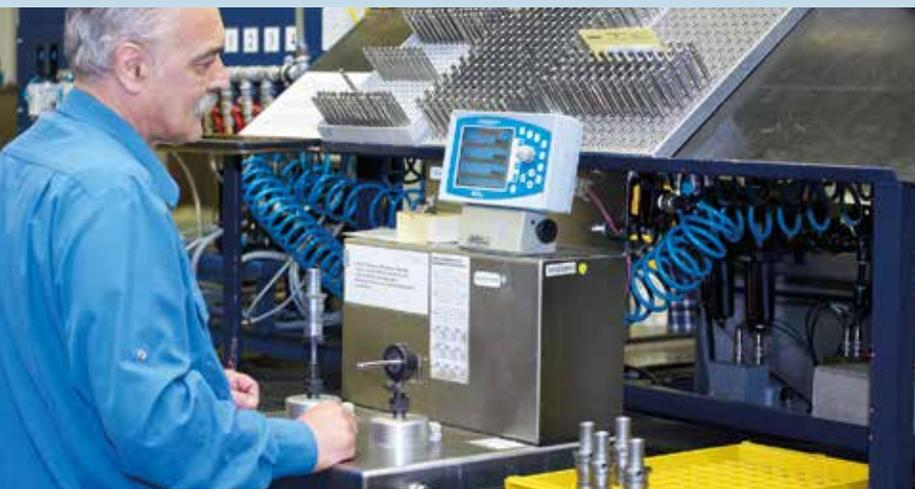
*Messen und Zusammenfügen einer Ventil-Kombination aus Kolben und Zylinder*
