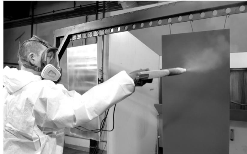
Unsere Pulverbeschichtungsanlage dient dem hausinternen Beschichten von Stahl- und Aluminiumkonstruktionen sowie Blechbauteilen zum Korrosionsschutz und der Schaffung optisch hochwertiger, emissionsarmer Sichtflächen. Dabei kommen matte oder stumpfmatte Pulver in RAL- oder NCS-Farben oder auch nach anderen Vorgaben zum Einsatz.
