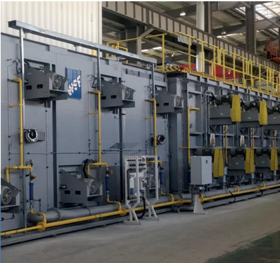
Wichtigstes Merkmal der WSP Bandschwebeöfen ist deren Langlebigkeit. Im Vergleich zu älteren Bauarten konnte die Standzeit der Beheizungstechnik (Flamm- und Strahlheizrohre oder auch Elektroheizelemente) erheblich verbessert werden.
