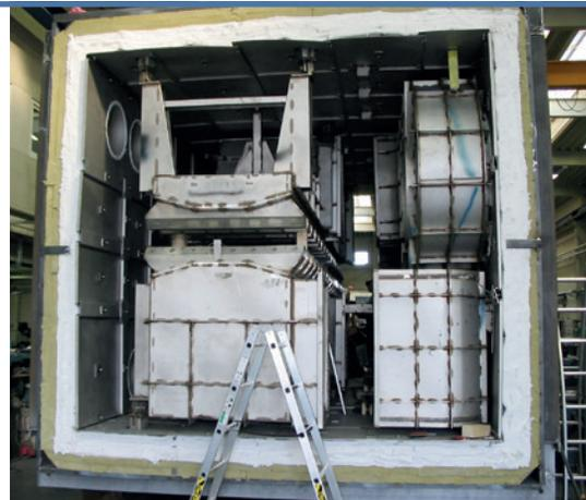
Aufbau eines modernen Bandschweißofens entsprechend dem Stand der Technik
