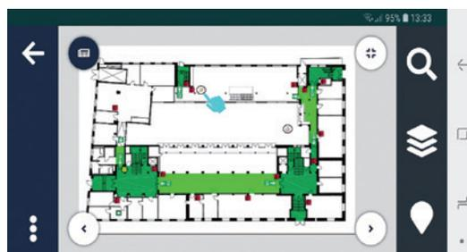
Screenshot einer Tablet-Oberfläche mit Gebäudeplan, Setzen eines Datenpunkts beim Ecomapping®
